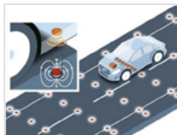
2014/03/26 マグネットで、最大誤差10cm未満の目に見えない「道路」を作り出す。すでにさまざまな速度域でのテストが繰り返されている
