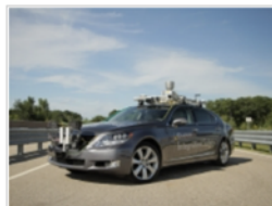
トヨタのシステムは自動追従型のクルーズコントロールと、衝突回避自動ブレーキを組み合わせたかたち「準自動型」となっている
